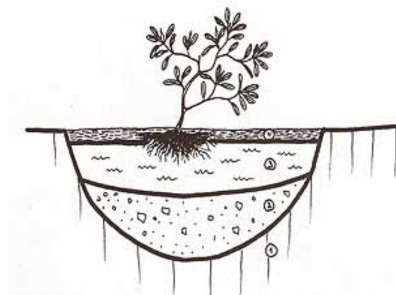
Рисунок 7 - Схема посадки: 1- грунт; 2- дренаж 15-40 см; 3- почвенная смесь 20-40 см; 4- хвоя (желательно сосновая) 5-15 см.
